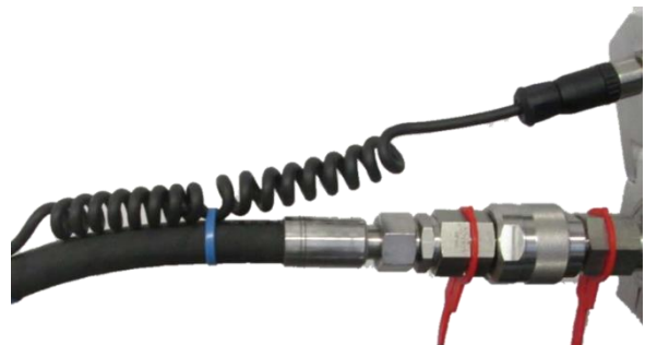
Fig. 5.6: Fijación del cable en espiral
