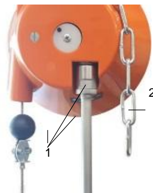
Fig. 5.2 – Réglage fin de l'équilibre à ressort
