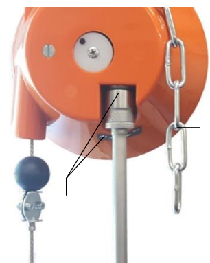
Abb. 5.5 – Feinabstimmung des Federzuges
