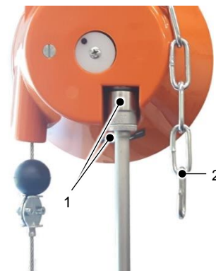
Fig. 5.3 – Réglage fin de l'équilibreur à ressort
