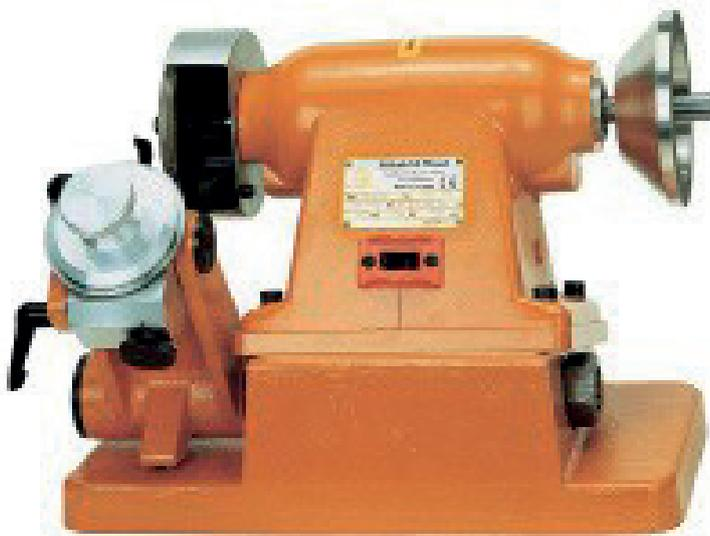
Ponceuse EFA 53 pour un réaffûtage idéal de l'EFA 620 Ent-lames d'écorcheur.
