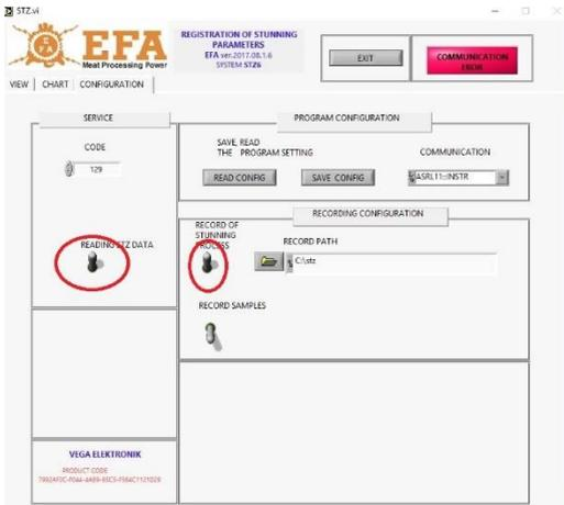
4. En casilla "**COMMUNICATION**" escoger número del puerto virtual "**COM**", el cual ha sido instalado junto con la instalación del Convertidor USB . Será "**ASRL**" + número del puerto instalado.
