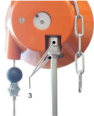
Abb. 5.3 – Einstellung des Federzuges
