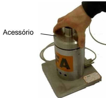
Para trocar os sensores, primeiro solte o cabo de conexão e solte o acessório.
