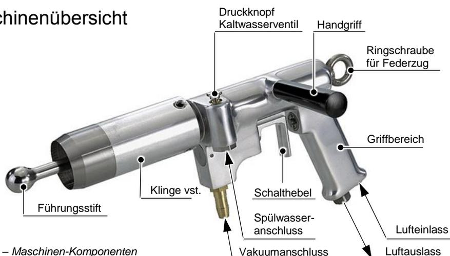
Abb. 5.4 – Maschinen-Komponenten
