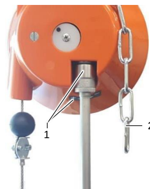
Fig. 5.2 – Ajuste preciso del equilibrador de muelle
