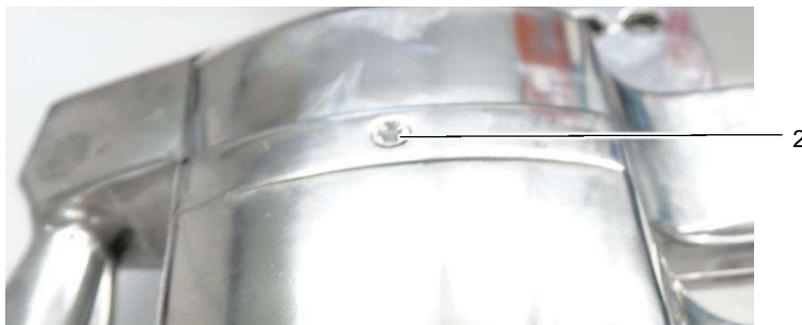
Para garantizar la lubricación de la corredera y el engranaje, la máquina debe engrasarse en las boquillas (1) y (2) con 1 - 2 disparos de la pistola de engrase.
