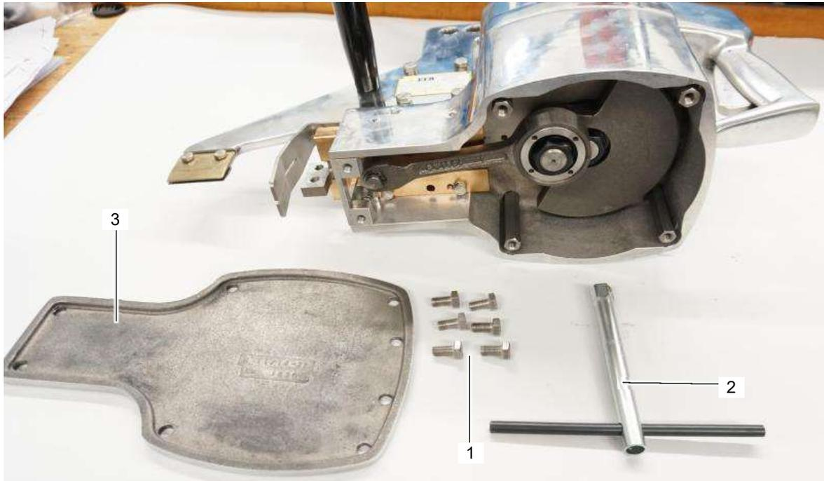
**Comprobar el juego de la corredera con un calibrador de espesores (0,02 – 0,06):**
