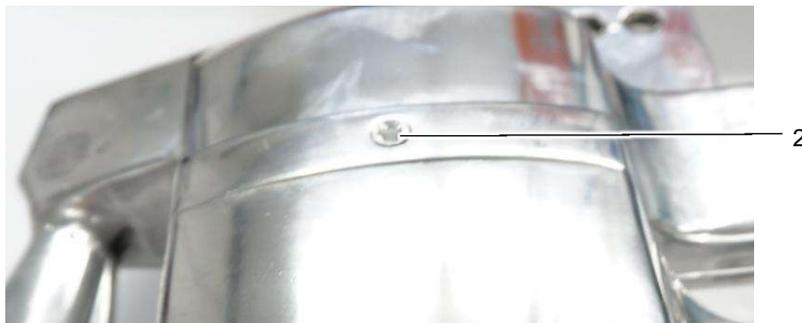
Um die Schmierung der Schieber und des Getriebes zu gewährleisten, muss die Maschine an den Schmiernippeln (1) und (2) mit 1 – 2 Stößen aus der Fettpresse gefettet werden
