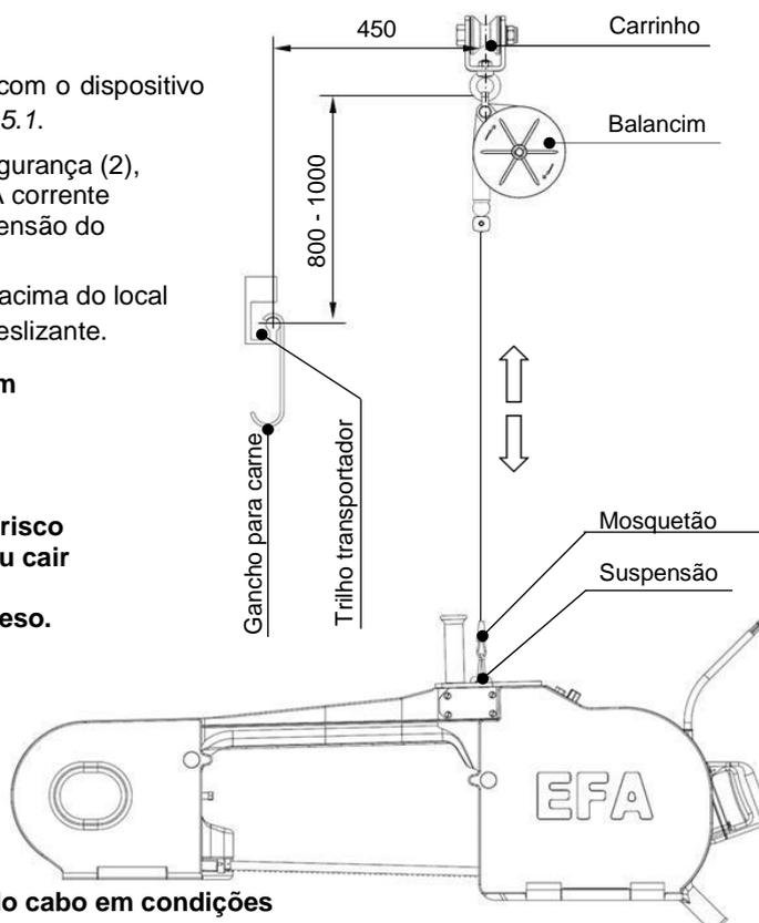
Fig. 5.1 – Sistema de alívio de peso (balancim)
