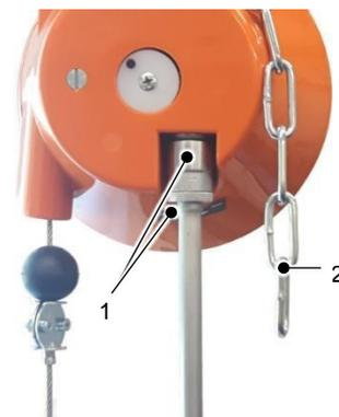
Fig. 5.2 – Ajuste fino do balancim
