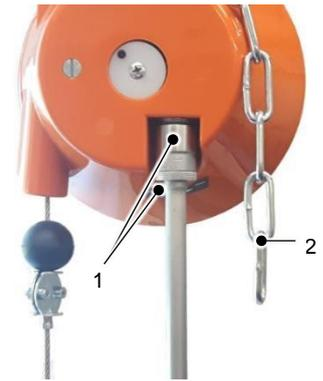
Fig. 5.2 – Ajuste preciso del equilibrador de muelle
