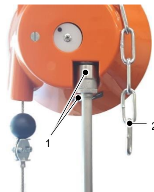
Fig. 5.2 – Ajuste preciso del equilibrador de muelle
