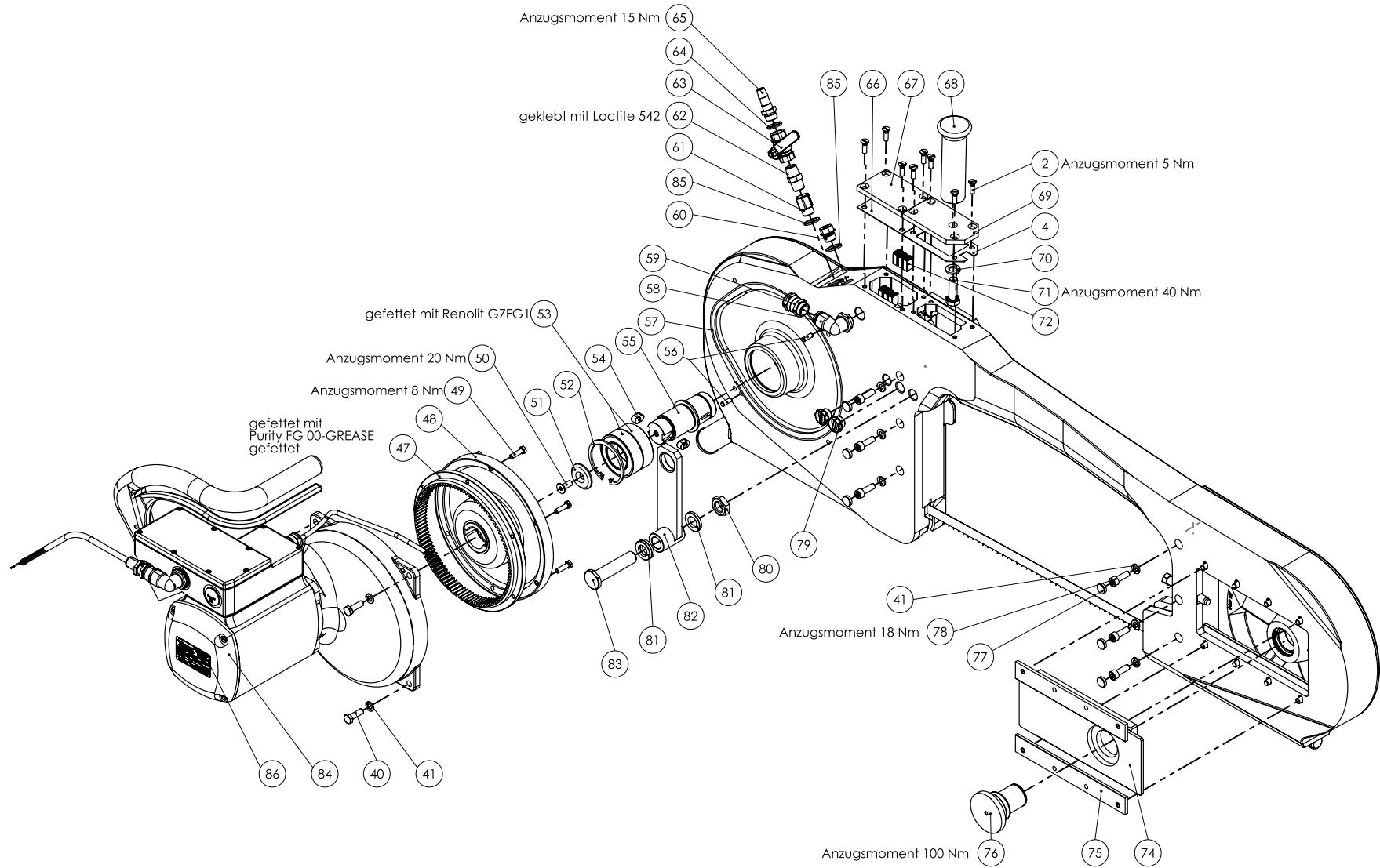
**Ersatzteilliste Halbierungssäge SB 289 EC 400 V 50 Hz (110890949)**
