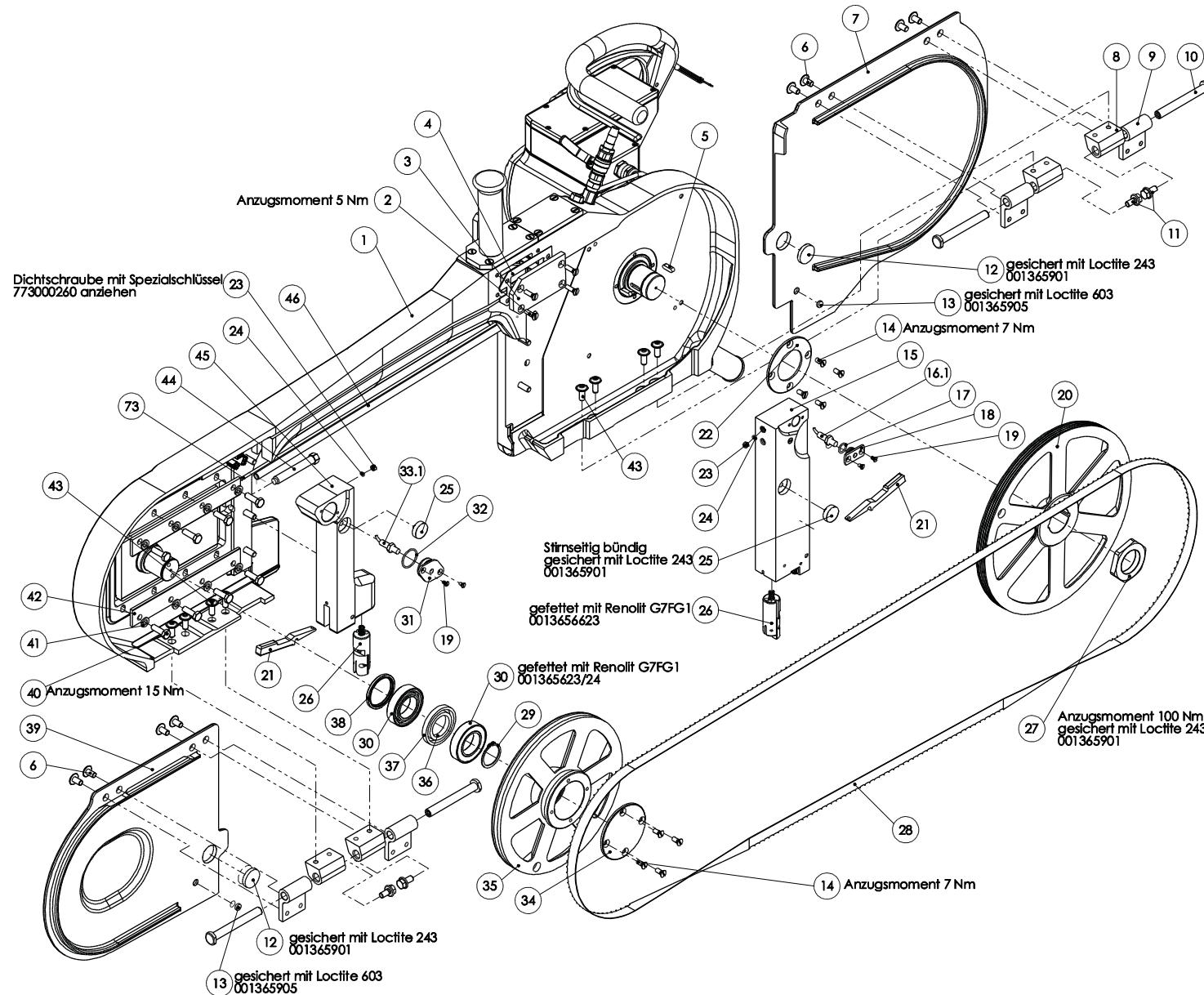
Ersatzteilliste Halbierungssäge SB 289 EC 400 V 50 Hz (110890949)
