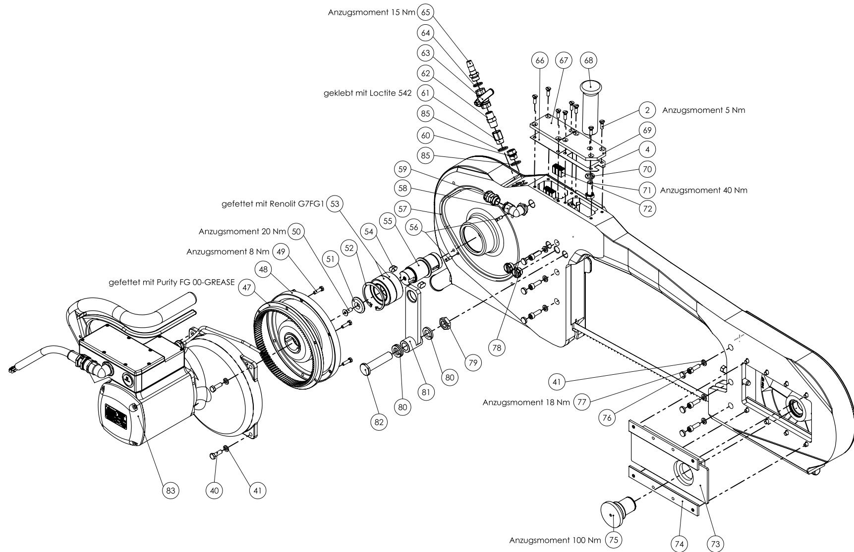
**Ersatzteilliste Halbierungssäge SB 289 EC 42 V 50 Hz (110890947)**
