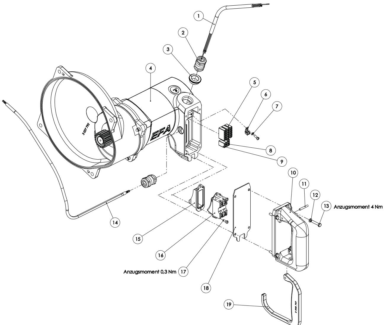
**Ersatzteilliste Halbierungssäge SB 287 E 208 V 60 Hz (110890919)**
