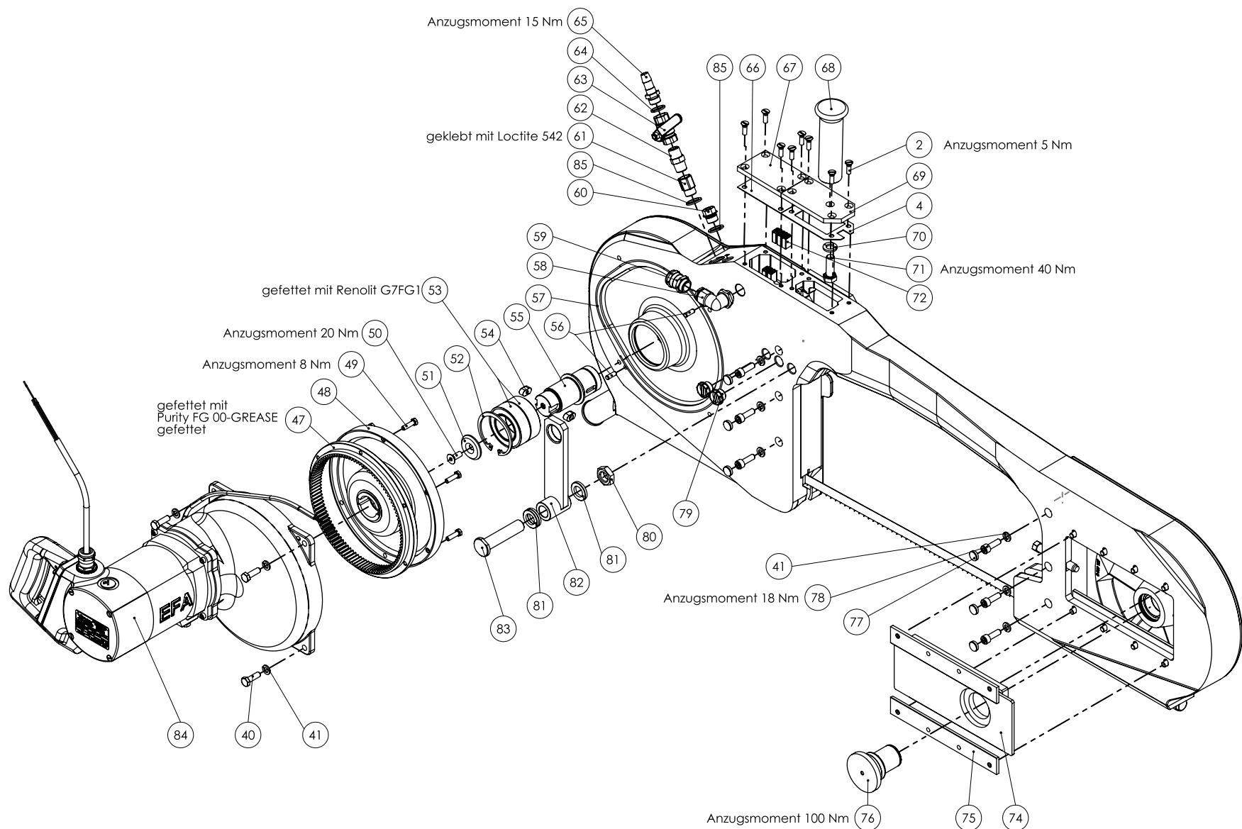
**Ersatzteilliste Halbierungssäge SB 287 E 208 V 60 Hz (110890919)**
